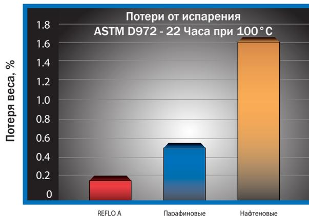
Более низкая летучесть масел REFLO A снижает перенос частиц масла парами, который часто наблюдается при использовании парафиновых и нефтяных масел. В связи с этим расход компрессорного масла снижен на 80%.
